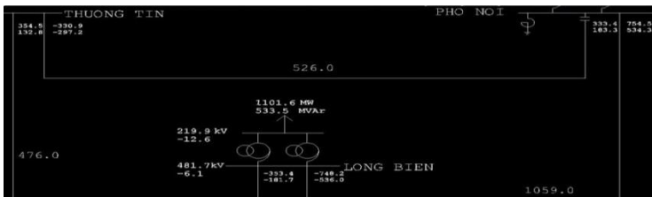
Hình 3.6. Giá trị điện áp nút và dòng điện trong mạch vòng Thường Tín - Phố Nối - Long Biên ở chế độ cao điểm mùa khô
