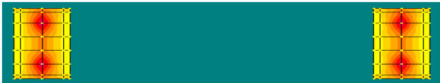
Hình 3.15. Biểu đồ phân bố ứng suất trong bộ móng trụ P5, P6
