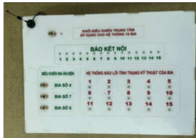
Hình 6.4: Bộ điều khiển trung tâm đã chế tạo.
