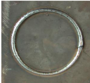
Hình 4.41. Mối hàn đã được hàn hoàn thiện (DUONGTRON)
