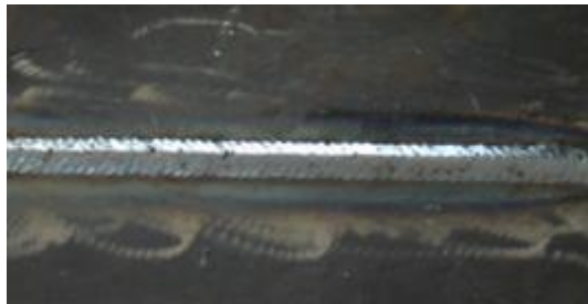
Hình 4.20. Mối hàn đã được hàn hoàn thiện(BTIG)
