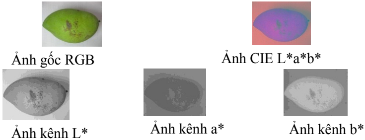
Hình 2.2 Chuyển đổi ảnh màu RGB sang ảnh màu CIE L^*a^*b^* và tách từng kênh màu L^* , a^* và b^* .
