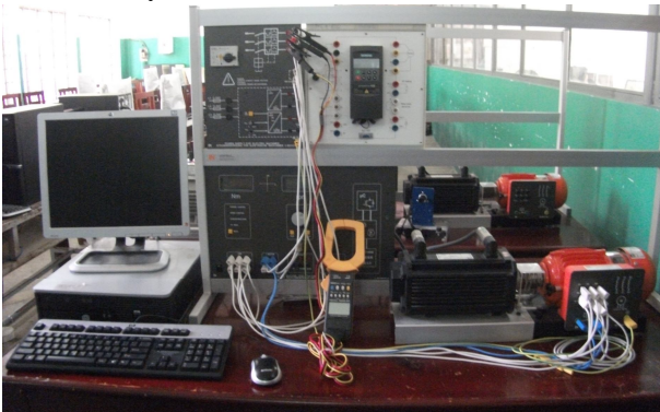
Hình 3-2. Mô hình điều khiển, giám sát động cơ.
