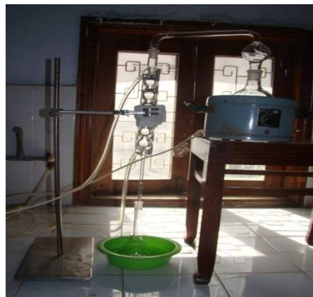
Hình 2.7. Sơ đồ chung cất thu hồi dung môi
