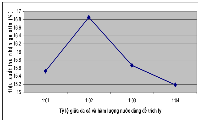
Hình 3.9. Ảnh hưởng của tỷ lệ da cá và hàm lượng nước đến hiệu suất thu nhận gelatin
