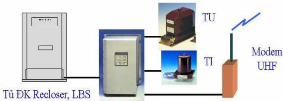
Hình 2.6. Tủ REC 523 tại các Reclose, LBS
