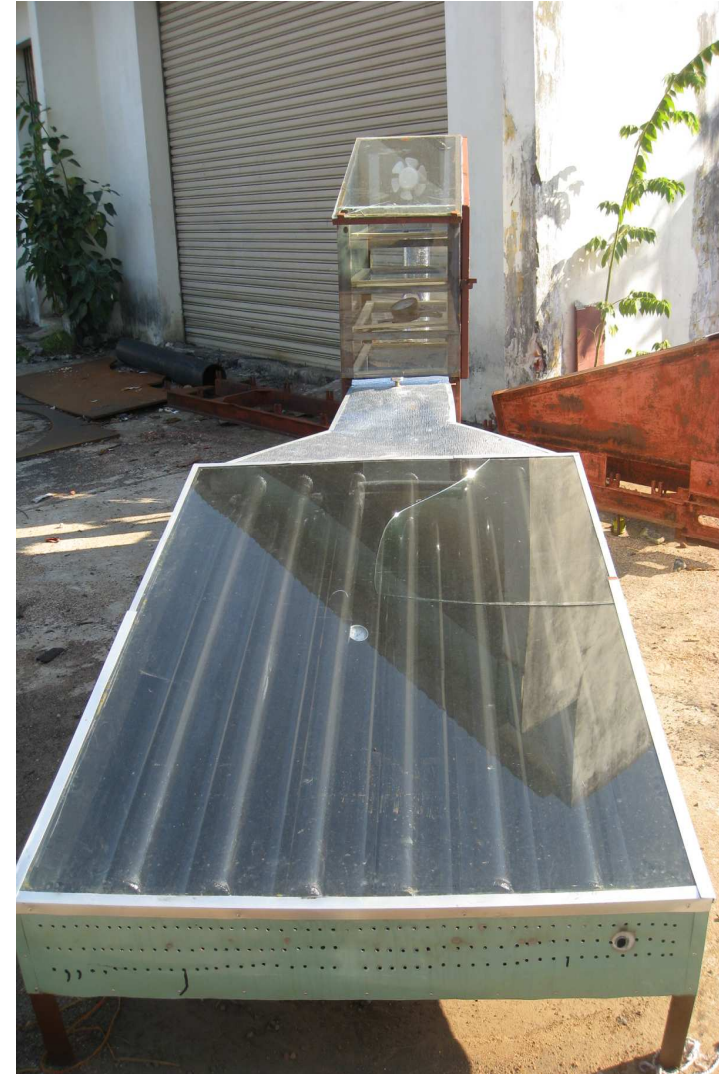
Hình 5.1a. Chế tạo mô hình thí nghiệm hệ thống sấy bằng NLMT có sử dụng Paraffin để trữ nhiệt
