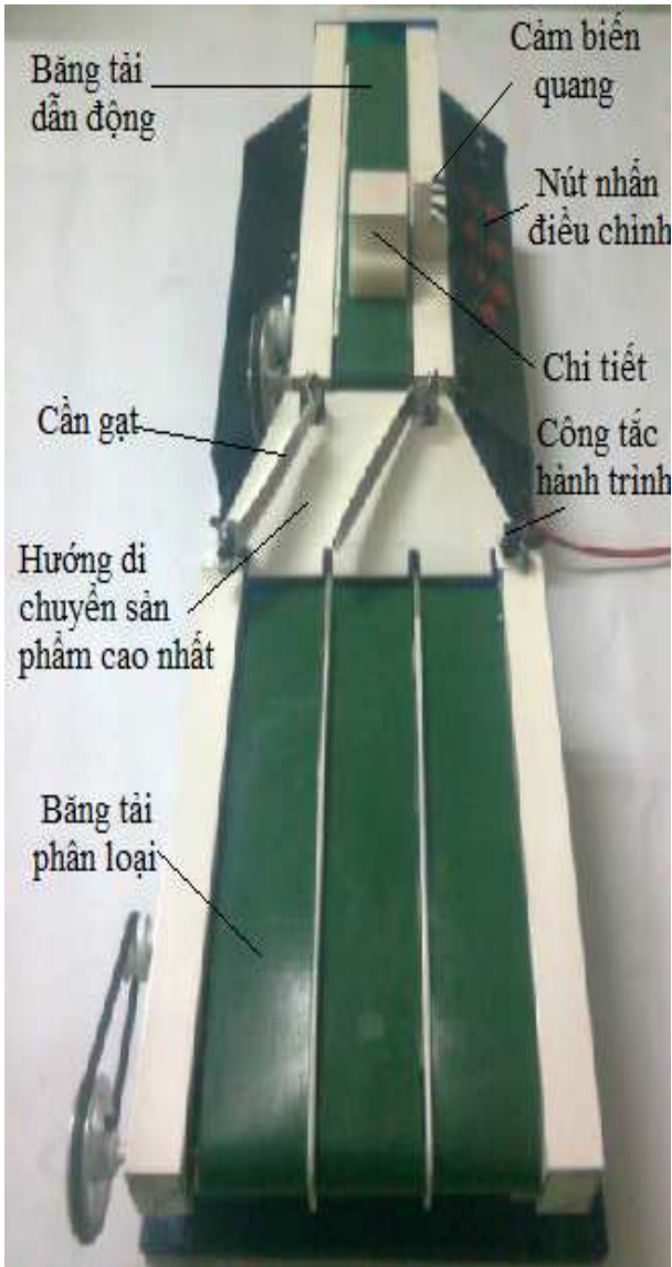
Hình 4.18: Cảm biến cao nhất phát hiện, nhận và truyền tín hiệu điều khiển
