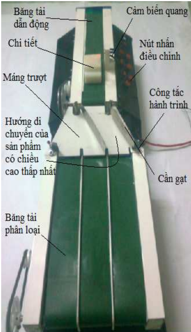
Hình 4.19: Cảm biến thấp nhất phát hiện, nhận và truyền tín hiệu điều khiển
