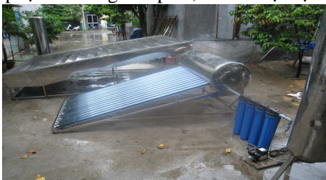
Hình 4.11: Hệ thống sản xuất nước cất thực tế
