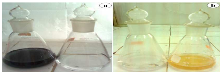
Hình 3.39. a: Mẫu nước thải nước lọc gỗ trước xử lý (trái) và sau xử lý (phải) b: Mẫu nước thải nước sơn gỗ trước xử lý (phải) và sau xử lý (trái)
