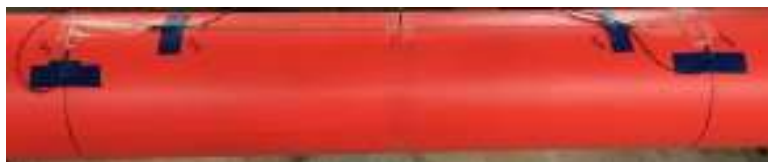
Hình 3-15. Sơ đồ bố trí các cảm biến đo biến dạng
